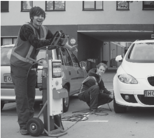
De perslucht voor de banden komt uit een compressor.
