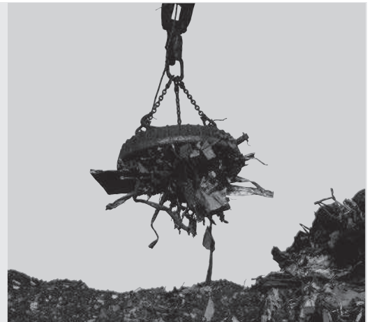
Afvalscheiding met behulp van een elektromagneet.
